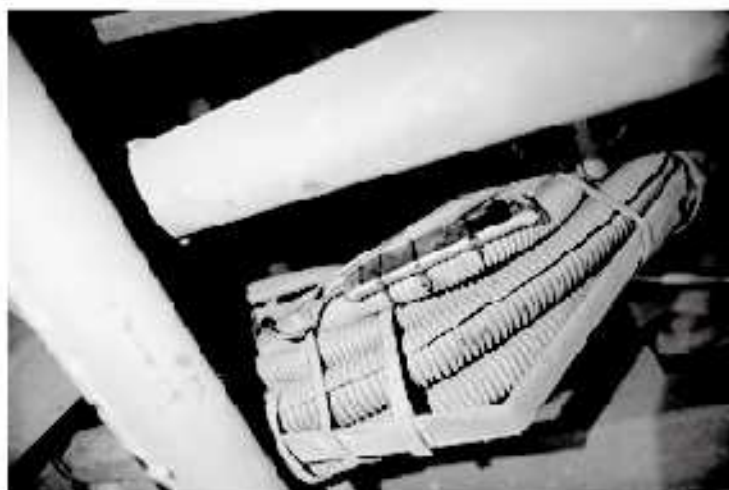
圖1. 前輪短天線的接收本體與底盤管束綑綁在一起
