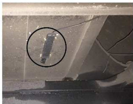
圖3. 後輪天線主體固定在底盤
